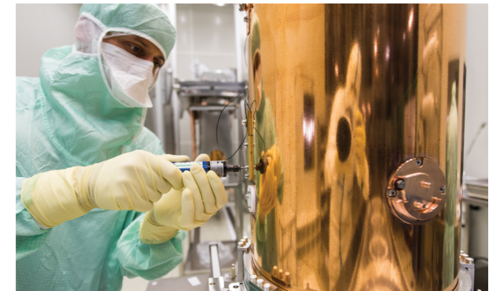
Assemblage des cavités de l'accélérateur HIE-ISOLDE en salle blanche. (CERN-PHOTO-201603-057-16)
