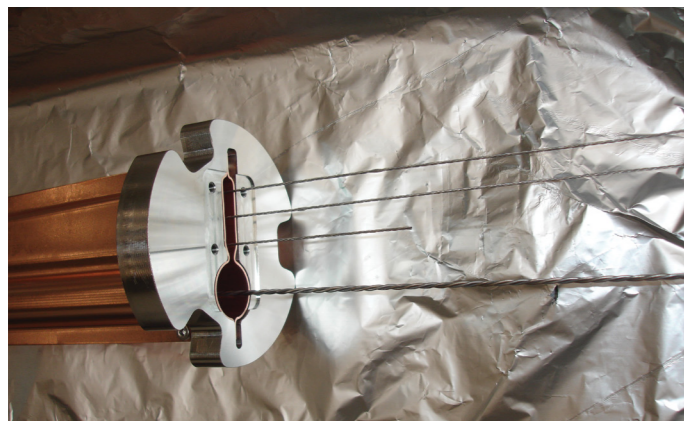
Prototype pour le développement du traitement de surface au CERN des chambres à vide du synchrotron suédois MAX IV. (OPEN-PHO-ACCEL-2016-006-1)
