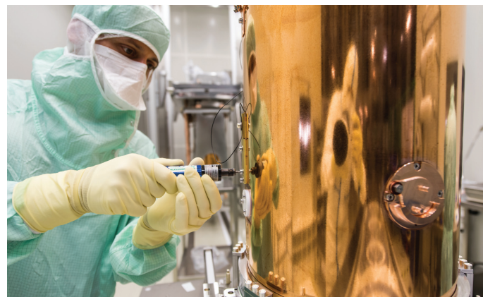
Assemblage des cavités de l'accélérateur HIE-ISOLDE en salle blanche. (CERN-PHOTO-201603-057-16)
