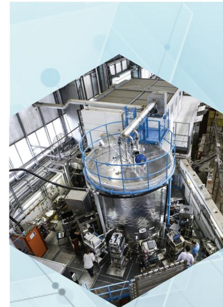
Les faisceaux de particules du Synchrotron à protons (PS) sont injectés dans l'environnement contrôlé et ultra-propre de CLOUD afin de simuler l'ensemencement des nuages. (CERN-EX-1310264-03)
