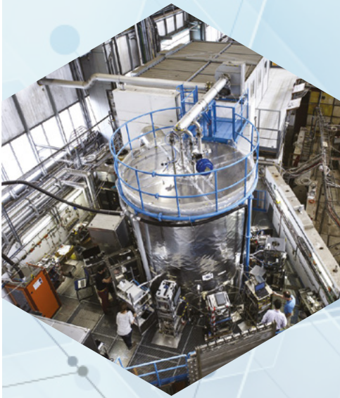
Les faisceaux de particules du Synchrotron à protons (PS) sont injectés dans l'environnement contrôlé et ultra-propre de CLOUD afin de simuler l'ensemencement des nuages. (CERN-EX-1310264-03)
