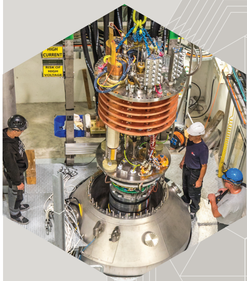
L'un des prototypes courts d'un quadripôle en niobium-étain pour le LHC à haute luminosité est inséré dans le tout nouveau banc de test vertical du hall de test des aimants supraconducteurs. (CERN-PHOTO-201708-191-20)
