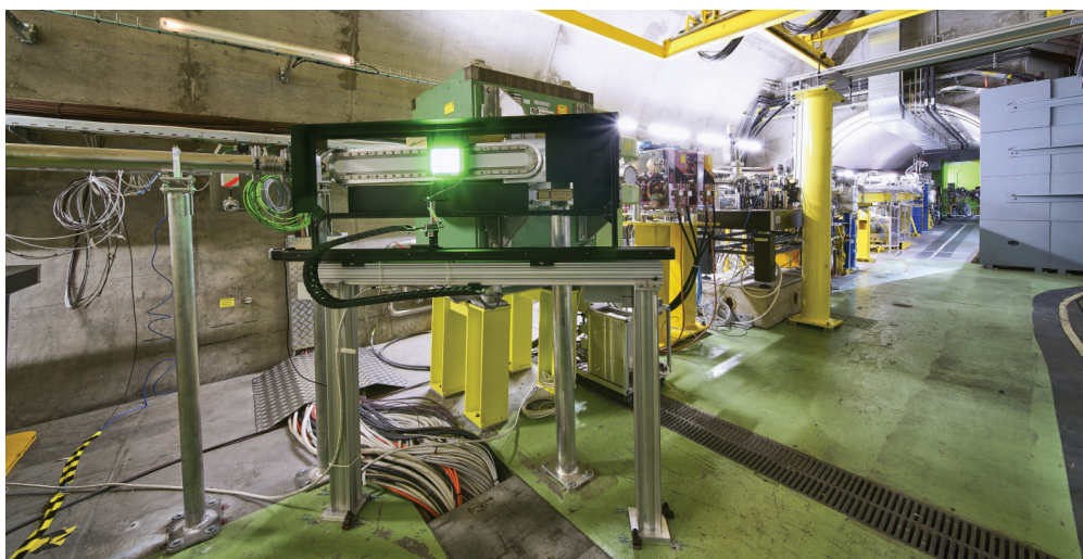
L'expérience AWAKE avec le système de spectromètre à électrons et la cellule plasma de 10 mètres. (CERN-PHOTO-201711-284-5)
