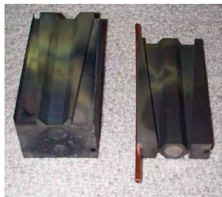
TRIUMF ISOL target Diffusion bonded Mo foils
